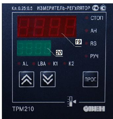
Рис. 5. Лицевая панель измерителя-регулятора TPM210.
